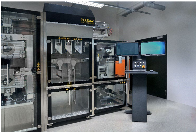
Bild 2: Seit 2021 werden am Fraunhofer ILT Laserprozesse für die Batteriefertigung in einem eigenen Batteriezentrum erforscht. Hier im Bild die Anlage mit der Multistrahloptik zur Laserbearbeitung. Im nächsten Schritt will Pulsar Photonics die für das NextGenBat-Projekt entwickelte Optik zur Serienreife bringen – im Idealfall mit Industriepartnern. © Fraunhofer ILT, Aachen.
